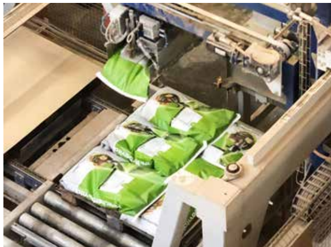
In 2017-2018 werd geïnvesteerd in een nieuwe volautomatische meng- en afzakinstallatie voor poeders.
